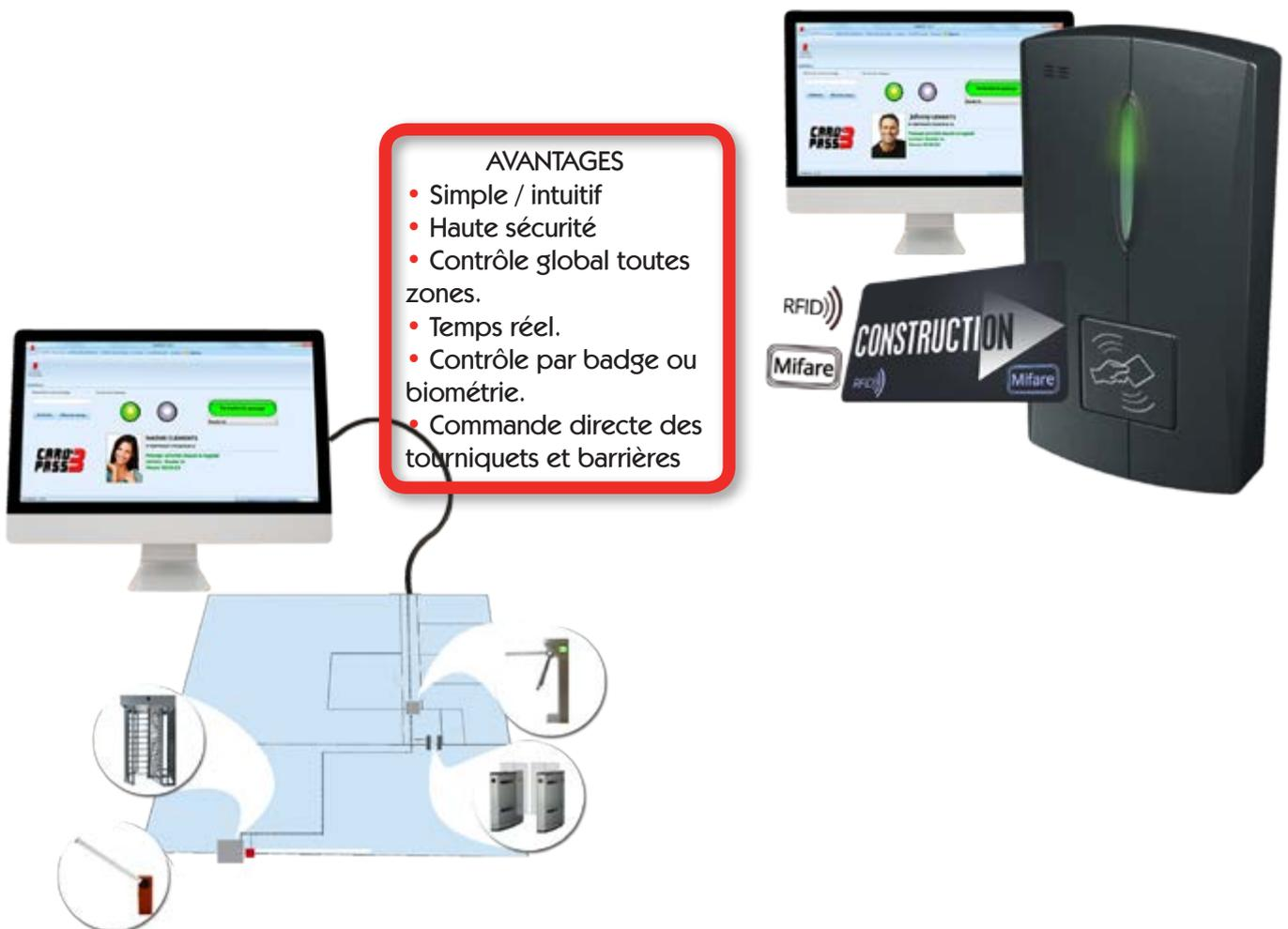
CardPass3 contrôle tous les accès à votre chantier: tourniquets tripodes, tourniquets pleine hauteur, portails, barrières levantes... Il permet aussi de différencier les zones ou par exemple d'autoriser un utilisateur à accéder par les tourniquets piétons mais pas par les accès véhicules. Comporte une gestion anti-passback qui rend impossible l'utilisation d'un même badge par deux utilisateurs en même temps.
